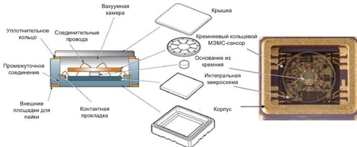
Кремниевый кольцевой МЭМС-сенсор, микросхема и кремниевое основание размещены в герметичной части корпуса с вакуумом, частично заполненным азотом.
