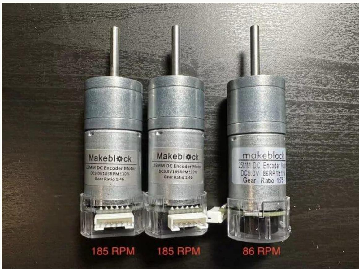
Энкодер, также известный как датчик угла поворота и преобразователь угловых перемещений, — это специальное устройство для точного измерения характеристик вращающихся объектов (например, вала двигателя). Он регистрирует нужные параметры и формирует электрические сигналы, содержащие необходимую информацию.
