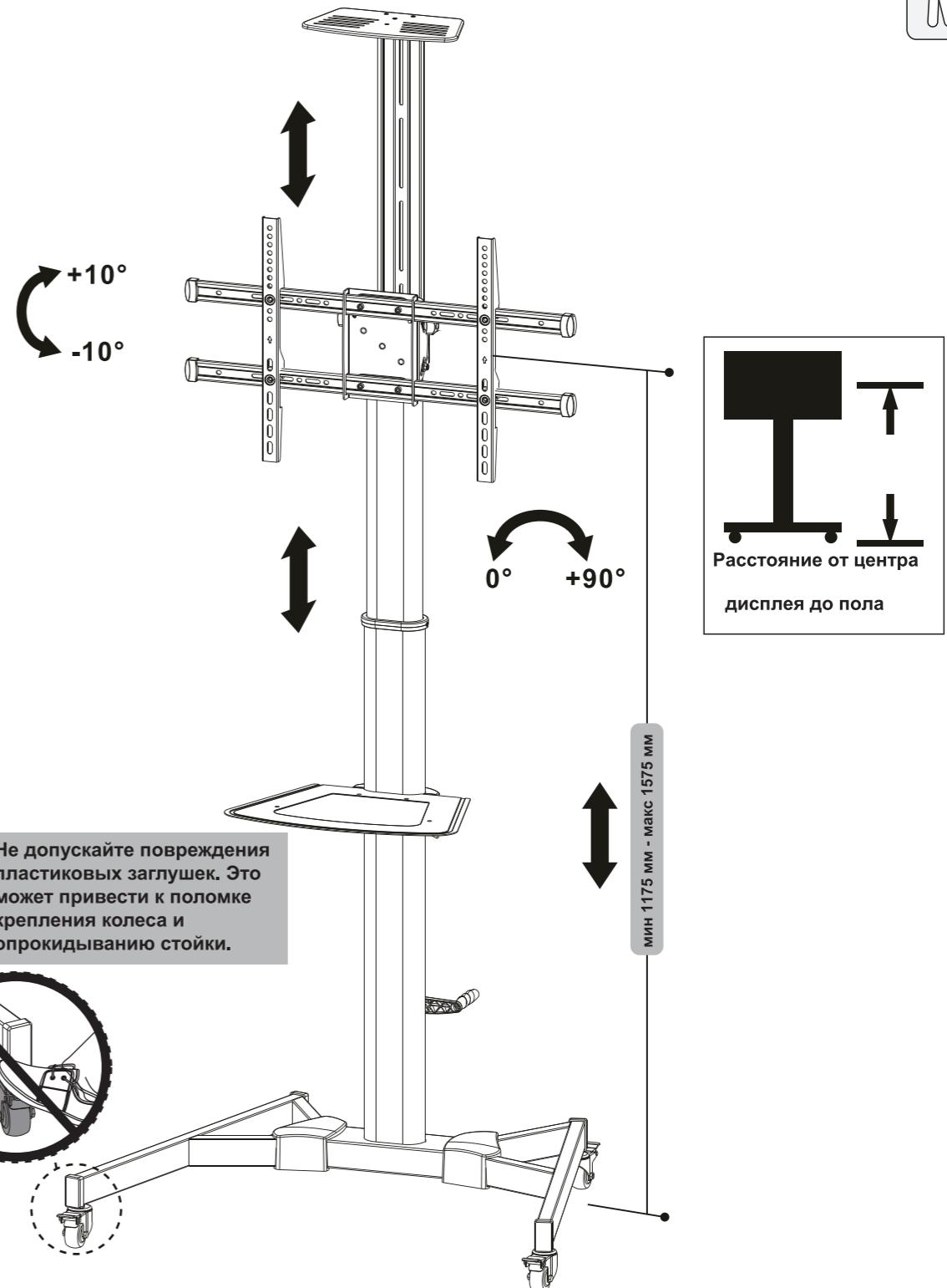
**Внимание:** Рекомендуем регулировать высоту стойки до установки на нее дисплея.
