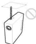
Используйте защитную планку, расположенную сбоку проектора, только для целей защиты от кражи, для чего к ней можно прикрепить, например, стандартный, имеющийся в продаже тросик. Если вы поднимите проектор, удерживая его за защитную планку, он может упасть, и возможно повреждение проектора.
