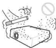
Избегайте установки проектора в сильно запыленных или задымленных местах. Это может привести к быстрому засорению воздушного фильтра, что станет причиной нарушения работы или повреждения устройства. Пыль, препятствующая прохождению воздуха через фильтр, может вызвать повышение температуры внутри устройства. Производите чистку фильтра при каждой замене лампы.
